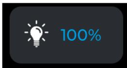
Qui è possibile selezionare l'illuminazione a LED nel microscopio premendo il regolatore a pressione/rotazione sui livelli 0 %, 25 %, 50 %, 75 % e 100 %.
