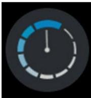
Più veloce è il ciclo di saldatura selezionato, più velocemente si può lavorare ed evitare che il pezzo si raffreddi troppo tra i punti di saldatura. Attenzione: un ciclo di saldatura più rapido aumenta anche l'apporto di calore al pezzo. Nel caso di leghe ad alta conducibilità termica, ciò può essere eventualmente vantaggioso.
