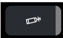
Qui si apre la valvola del gas nel dispositivo. Questa funzione viene impiegata per potere impostare correttamente la portata di gas sul regolatore di portata.
