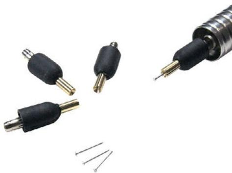
Un adattatore per la saldatura PIN è necessario per il manipolo per saldare perni (p.es. di orecchini) utilizzando la modalità PIN. Il set è composto da adattatori con  $\varnothing$  0,65, 0,8, 0,9 e 1 mm. Per lavorare in modalità PIN è necessario anche l'interruttore a pedale (numero di articolo 100 850). La manipolazione e l'uso degli adattatori sono spiegati nel capitolo 6.4.
