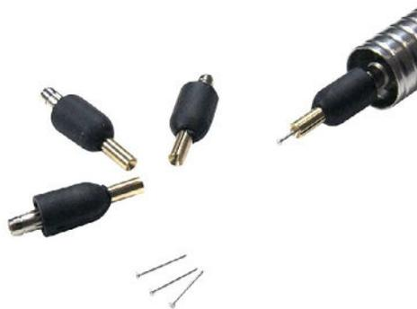
Se necesita un adaptador de soldadura PIN para que la pieza de mano de soldadura suelde en pernos de pendientes con el modo PIN. El juego consta de adaptadores de  $\varnothing$  0,65, 0,8, 0,9 y 1 mm. El interruptor de pedal (nº art. 100 850) también es necesario para trabajar en modo PIN. El manejo y el trabajo con los adaptadores también se explican en el capítulo 6.4.
