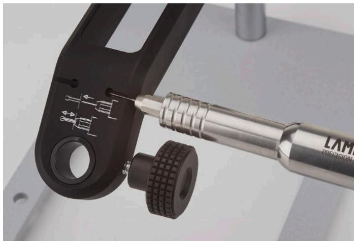
Fig. 5.2 Ajuste de longitud del electrodo con el brazo de sujeción del portaútil
