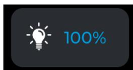
Hier kann die Helligkeit der LED-Beleuchtung im Mikroskop, durch Drücken des Dreh-Drück-Reglers, in den Stufen 0 %, 25 %, 50 %, 75 % und 100 % gewählt werden.
