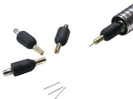
Zum Aufschiessen von Pins und Ohrsteckern mit dem PIN-Modus wird ein PIN-Schweißadapter für das Schweißhandstück benötigt. Das Set besteht aus Adaptern mit  $\varnothing$  0,65, 0,8, 0,9 und 1 mm. Zum Arbeiten im PIN-Modus ist zusätzlich noch der Fußschalter (Art.nr. 100 850) erforderlich. Die Handhabung und das Arbeiten mit den Adaptern werden auch in Kapitel 6.4 erklärt.
