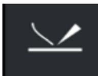
Fusión de alambre de soldadura. Utilice alambre de la misma aleación con un diámetro de aprox. 0,4 mm.
