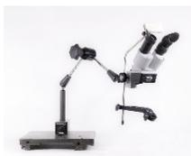
Variabel einstellbares Mikroskop ausgestattet mit Gelenkarm und schaltbarem Magnetfuß, elektronisch gesteuertem Augenschutzfilter (DIN3 / DIN11), 10-fach Vergrößerung und LED-Beleuchtung 3 W im Mikroskopkopf, Schutzschild, Handstückhalter und individuell verstellbarer Kopfstütze mit Ersatz-Stirnpolster. Empfohlen zur Verwendung auf Stahl-Werktischen und -oberflächen.
