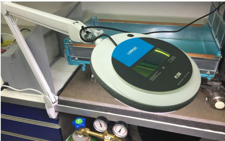
Die Optikeinheit bietet hohe Flexibilität wenn es um das Verschweißen von großen Bauteilen geht. Der zweiteilige Schwenkarm kann über 1 m bewegt und arretiert werden. Dabei bietet die LED Beleuchtung ein ausgezeichnetes Arbeitslicht und ist unabhängig schaltbar vom Schweißgerät. Lediglich die Optik mit Augenschutz wird vom M280 oder PUK U5+ gesteuert.
