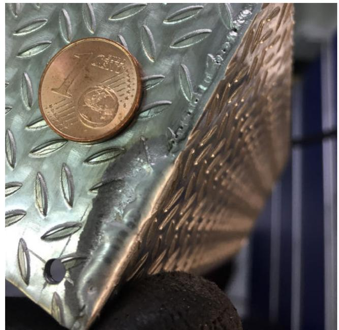
Unter meiner feinen 2 mm „Anfängernaht“ zu sehen: Eine grobe Naht mit über 6 mm Dicke. Geschweißt mit einem AC/DC Profigerät aus der Industrie von einem Berufsschweißer mit Zertifikat. Die kleine Naht hält genauso stabil und sieht besser aus.
