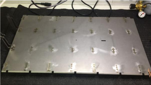
Eine Schweißhilfe ist sinnvoll wenn es um kompliziertere Verbindungen geht, die absolut passen müssen in Länge und Winkel.
