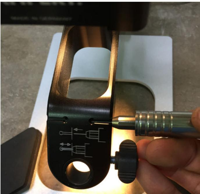
Eine genaue Justierung der Elektrode ist mittels Lehre möglich. Für Links- wie auch für Rechtshänder
