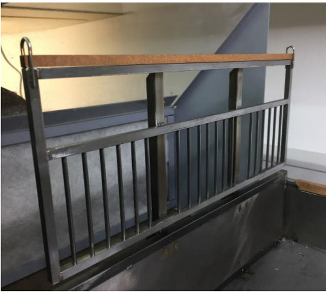
Rohbau Rückwandschutz, fertig verschweißt...
