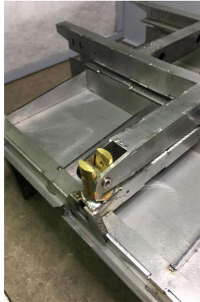
Die Messinglager wurden an den Stahlträger mit dem PUK U5 + geheftet und anschließend weich verlötet.
