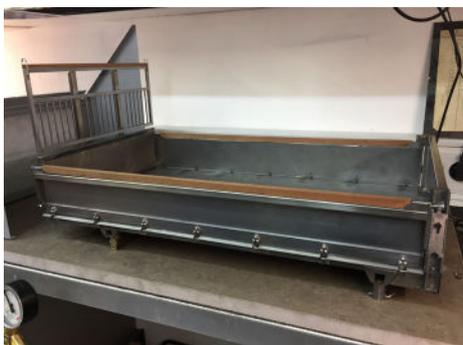
Als Anwendungsbeispiel wird eine funktionsfähige 3-Seitenkipprücke im Maßstab 1:8 gebaut. Stahl, Edelstahl und Messing kommen als Materialien zum Einsatz.
