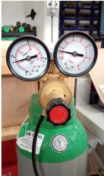
Mit dem roten Drehknopf vorne am Druckminderer konnte ich den Gasfluss auf ca. 3 l/min einstellen
