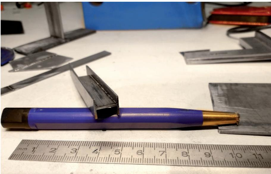
Doppel-T-Träger aus 1-mm-Stahl – mal schnell zusammengeschweißt
