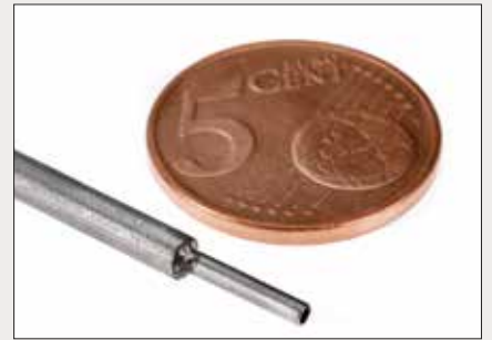
Dichtschweißen von Druckleitungen
