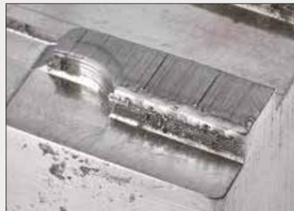
Auftragsschweißungen von Kanten
