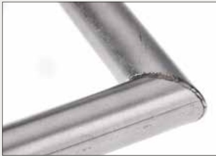
Schweißnaht an Rohr-Eckverbindung
