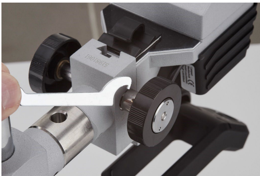
Fig. 7.2 Freno del microscopio flojo
