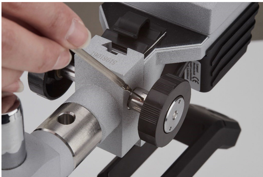
Fig. 7.1 Apertura del freno del microscopio
