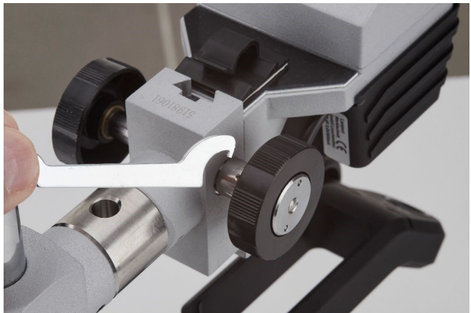
Abb. 7.2 Lösen der Mikroskop-Bremse
