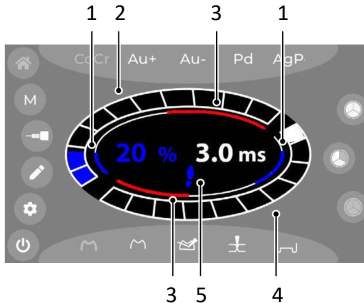
Abb. 6.3 Schweißleistung und Impulsdauer
