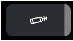
Hier wird das Gasventil im Gerät geöffnet. Diese Funktion wird verwendet, um den Gasdurchfluss am Durchflussregler korrekt einstellen zu können (Empfohlener Gasdurchfluss 2-3 l/min).
