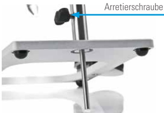
Sie haben ebenfalls die Möglichkeit, den Neigungswinkel des Mikroskops zu verändern. Lösen Sie dazu die Arretierschraube in der Stativstange. Eine Metallstütze fährt jetzt heraus und bildet ein weiteres Standbein. Bewegen Sie das Mikroskop in die gewünschte Position und fixieren die Schraube wieder.
