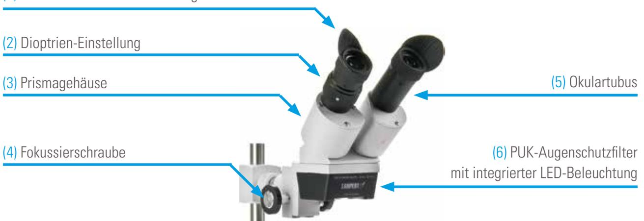
Schauen Sie durch die beiden Okulare (1) und bewegen die Okulartuben (5), indem Sie das Prismagehäuse (3) nach innen oder außen bewegen. Der Augenabstand ist korrekt, wenn die Gesichtsfelder durch beide Okulare betrachtet vollständig sind und sich zu einem gesamten Gesichtsfeld ergeben. Der Augenabstand sollte für jeden Anwender individuell eingestellt werden. Eine Distanzhülse sorgt für den korrekten Abstand zur Fokussierung.
