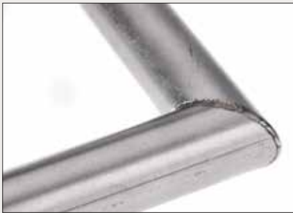
Schweißnaht an Rohr-Eckverbindung
