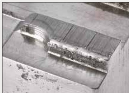
Auftragsschweißungen von Kanten
