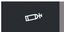
Hier wird das Gasventil im Gerät geöffnet. Diese Funktion wird verwendet, um den Gasdurchfluss am Durchflussregler korrekt einstellen zu können (Empfohlener Gasdurchfluss 2-3 l/min).
