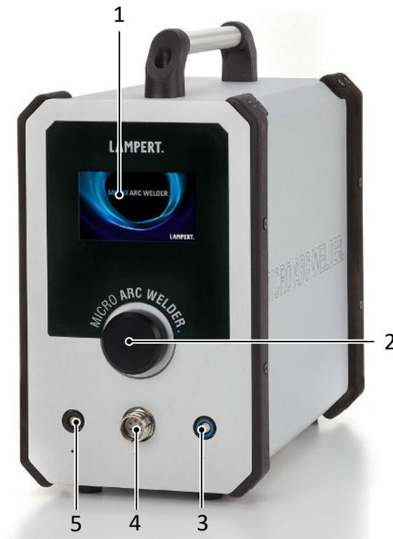
Abb. 3.2 Micro Arc Welder Vorderseite
