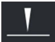
Einstellung für Blech- oder Drahtteile gleich oder dünner als ca. 0,3 mm. Besonders bei kurzen Schweißzeiten hat diese Einstellung eine sehr geringe Wärmeeinwirkung ( $\leq 0,3$  mm).
