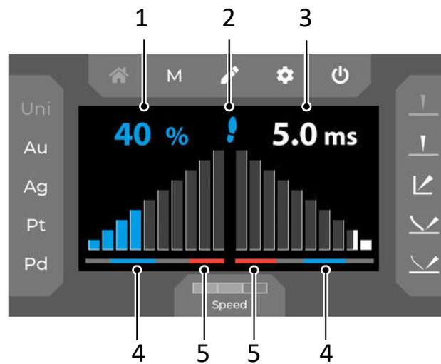
Abb. 6.3 Schweißenergie und Impulsdauer
