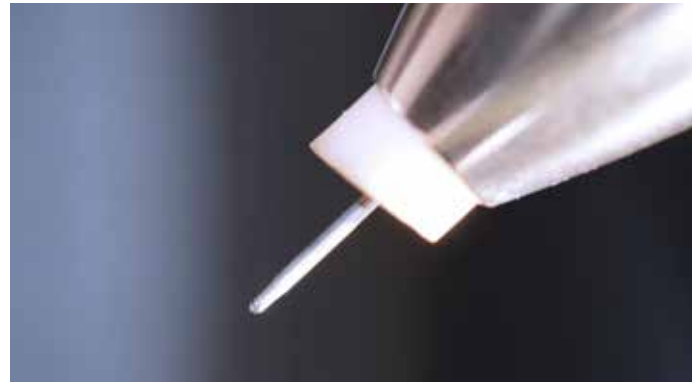
WLA Ø 0,6 mm nach 700 Punkten / after 700 spots
