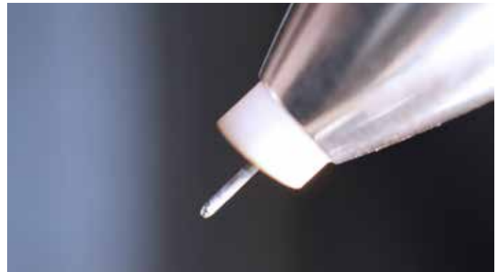
WLA Ø 0,6 mm nach 700 Punkten / after 700 spots
