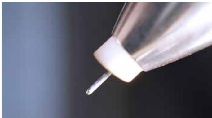
Der Unterschied beim Abbrand ist deutlich an Form und Länge der Elektrodenspitze ersichtlich.
