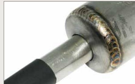
Orbitalanwendung, hochvakuumdichte Verschweißung einer Edelstahlhülse (Durchmesser 12 mm)
