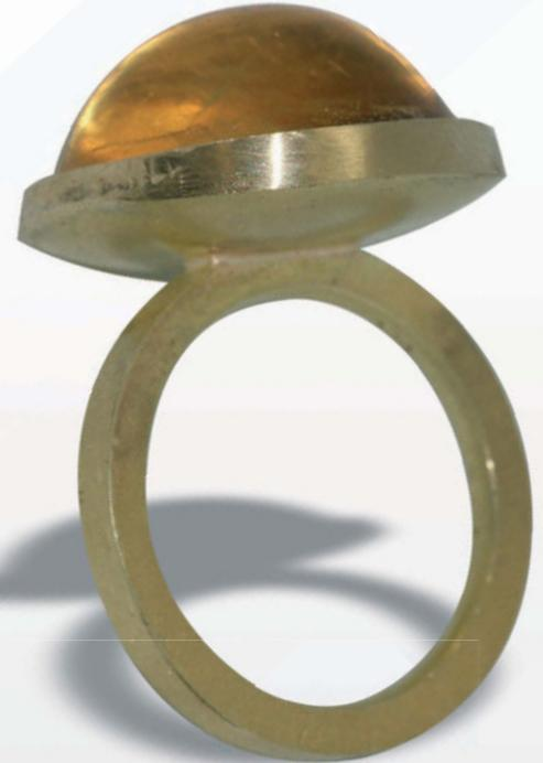
Außerdem wird an der Zarge eine Fase angefeilt. Sie sorgt für eine tiefere Verschweißung.
