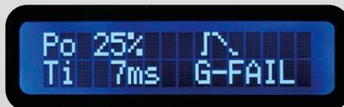
PUK 3 und PUK 3s können ohne Schutzgas nicht betrieben werden. Ist kein Schutzgas angeschlossen, ist im Display eine Fehlermeldung zu lesen. (Es ist normal, dass direkt nach einem Schweißvorgang kurz diese Fehlermeldung zu lesen ist)
