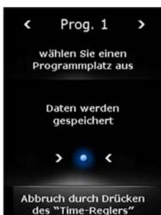
Durch Drücken des Schweißzeitreglers (25) wird das Programmiermenü aufgerufen. Im ersten Schritt wählen Sie durch Betätigen der Pfeile den Programmplatz aus, in dem Sie Ihre eigenen Einstellungen
