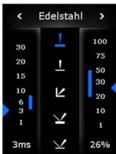
1. Im oberen Displaybereich des Hauptmenüs wird durch Drücken der Pfeilflächen das zu schweißende Metall ausgewählt.
