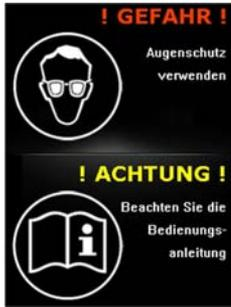
Öffnen Sie zuerst das Gasflaschenventil vorsichtig. Schalten Sie dann den Netzhauptschalter (2) an der Gehäuserückseite auf die Stellung "I" – auf dem Display erscheint der Sicherheitshinweis zu Augenschutz und Bedienungsanleitung. Bestätigen Sie die Einhaltung dieser Sicherheitsanweisungen, indem Sie einen der Drehregler drücken oder das Touchdisplay berühren.
