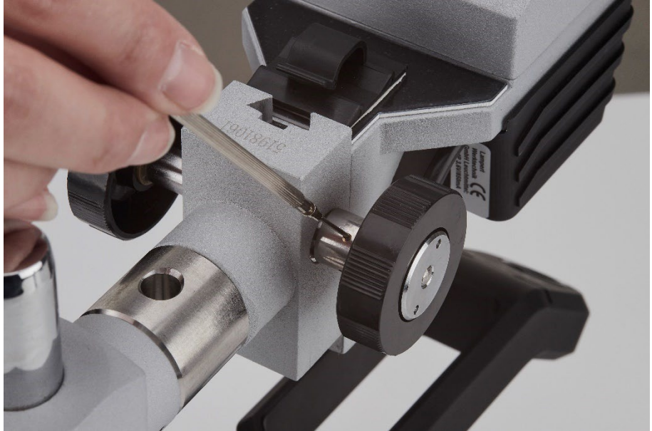
Fig. 7.1 Ouverture du frein du microscope
