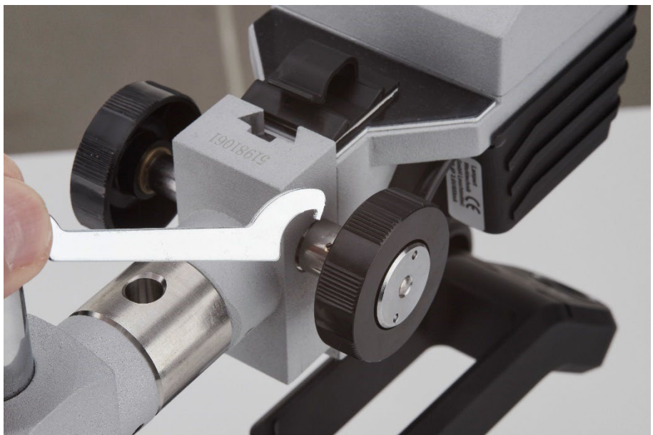
Fig. 7.2 Desserrage du frein du microscope
