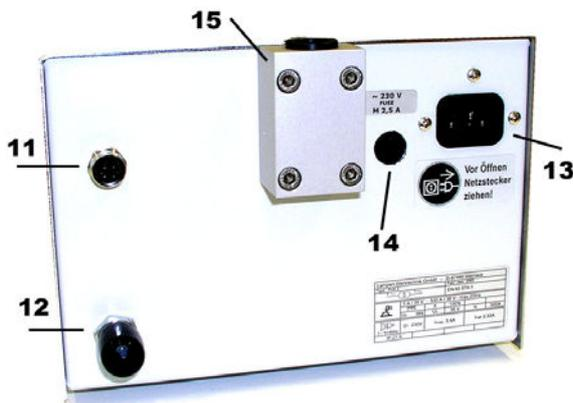
**ANSCHLUßBUCHSE FÜR OPTIKEINHEIT (11)**
