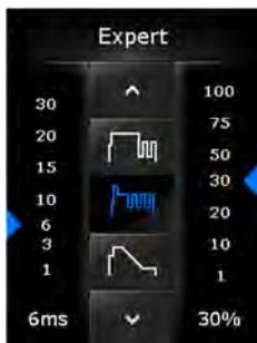
Nach dessen Aktivierung erscheint der Experten-Modus als eigene Bedienebene, die durch Drücken des Leistungsreglers erreichbar ist. Im Expertenmodus sind die verschiedenen Schweißkurven zu finden, die in der Startebene für die voreingestellten Metalle und Schweißgeometrien entwickelt und
