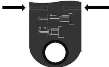
Die korrekte Elektrodenlänge lässt sich mit den im Handstückhalter angebrachten Einfräsungen (Abb. 4) leicht kontrollieren und ggfls. korrigieren.
