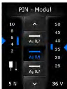
Nach dessen Aktivierung erscheint das Bedienmenü des PIN-Moduls als eigene Bedienebene, die durch Drücken des Leistungsreglers (26) erreichbar ist. Das PIN-Menü dient zur Steuerung des als Zubehör erhältlichen PIN-Moduls, mit dem Ohrsteckerstifte und ähnliche Furnituren halbautomatisch aufgeschweißt werden können.
