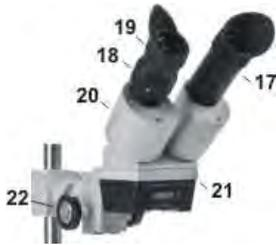
Montieren Sie ein Schweißhandstück mit eingespannter Elektrode im Haltearm. Drehen Sie den Fokussierknopf (22) auf einen mittleren Fokusbereich. Justieren der Montagehöhe des Mikroskopkopfes: Halten Sie den Mikroskopkopf (21) mit einer Hand, ohne dabei eine Linse zu berühren, und lösen mit der anderen Hand die
