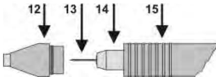
Düse (12) leicht hin- und herdrehen und dabei vom Handstück (15) abziehen. Diese ist lediglich aufgesteckt, nicht verschraubt.
