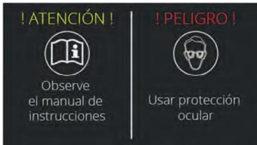
Abra primero la válvula del bombona de gas con sumo cuidado. A continuación coloque el interruptor principal de red (2) en la parte posterior de la carcasa en la posición “I” – aparece en pantalla la advertencia de seguridad sobre la protección ocular y el manual de operación. Confirme el cumplimiento de estas advertencia de seguridad, pulsando el regulador giratorio o tocando la pantalla táctil.
