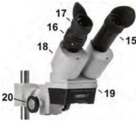
Monte en el brazo de soporte un portaútil de soldadura con el electrodo colocado. Gire la perilla de enfoque (20) hasta un rango de enfoque medio. Calibración de la altura de montaje del cabezal del microscopio: Sostenga con una mano el cabezal del microscopio (19), sin tocar ninguna de las lentes, y afloje con la otra mano
