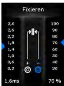
Después de su activación (véase también el punto 5.5 / Ajustes), aparece el modo 'Soldadura de fijación' como nivel de usuario adicional, al cual se puede acceder pulsando el control de potencia.
