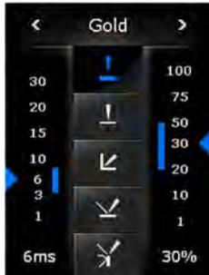
1. Pulsando los botones de flecha en la parte superior de la pantalla del menú principal, se selecciona el metal que se va a soldar.
