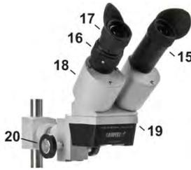
Monte en el brazo de soporte un portaútil de soldadura con el electrodo colocado. Gire la perilla de enfoque (20) hasta un rango de enfoque medio. Calibración de la altura de montaje del cabezal del microscopio: Sostenga con una mano el cabezal del microscopio (19), sin tocar ninguna de las lentes, y afloje con la otra mano el tornillo
