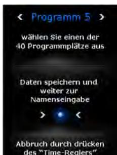
Durch Drücken des Schweißzeitreglers (27) wird das Programmiermenü aufgerufen. Im ersten Schritt wählen Sie durch Betätigen der Pfeile den Programmplatz aus, in dem Sie Ihre eigenen Einstellungen abspeichern möchten. Danach speichern Sie Ihre Daten, indem Sie die Schaltfläche mit dem
