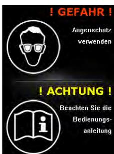
Öffnen Sie zuerst das Gasflaschenventil vorsichtig. Schalten Sie dann den Netzhauptschalter (2) an der Gehäuserückseite auf die Stellung "I" – auf dem Display erscheint der Sicherheitshinweis zu Augenschutz und Bedienungsanleitung. Bestätigen Sie die Einhaltung dieser Sicherheitsanweisungen, indem Sie einen der Drehregler drücken.
