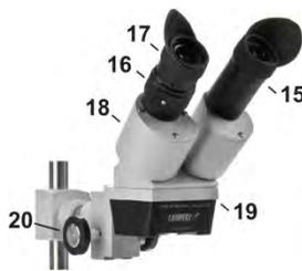
Montieren Sie ein Schweißhandstück mit eingespannter Elektrode im Haltearm. Drehen Sie den Fokussierknopf (20) auf einen mittleren Fokusbereich. Justieren der Montagehöhe des Mikroskopkopfes: Halten Sie den Mikroskop-Kopf (19) mit einer Hand, ohne dabei eine Linse zu berühren, und lösen mit der anderen Hand die
