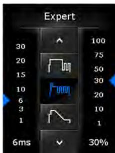
Nach dessen Aktivierung erscheint der Experten-Modus als eigene Bedienebene, die durch Drücken des Leistungsreglers erreichbar ist. Im Expertenmodus sind die verschiedenen Schweißkurven zu finden, die in der Startebene für die voreingestellten Metalle und Schweiß-Geometrien entwickelt
