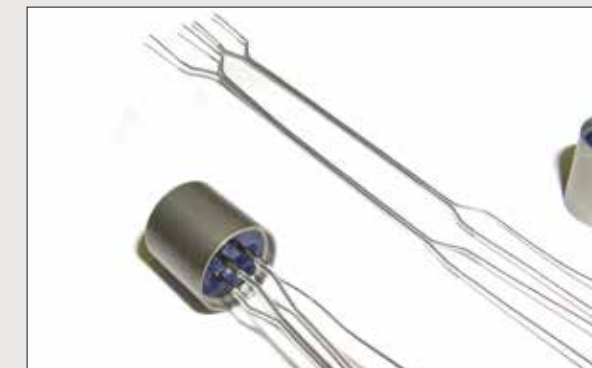
Feinschweißungen an elektronischen Bauteilen wie z. B. an Thermoelementen
