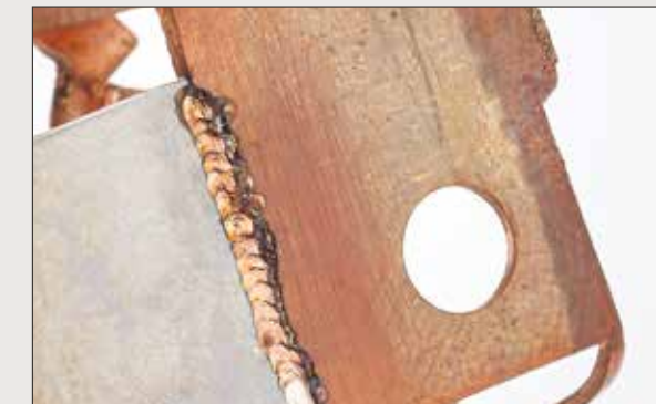
Materialmix aus verschiedenen Legierungen möglich (Abb. zeigt Kupfer und Edelstahl)
