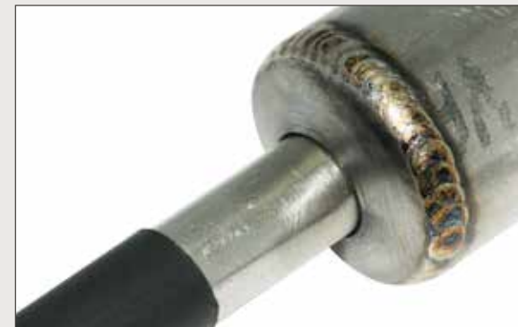
Orbitalanwendung, hochvakuumdichte Verschweißung einer Edelstahlhülse (Durchmesser 12 mm)
