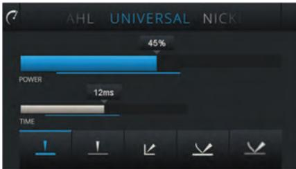
1) Im oberen Displaybereich des Hauptmenüs wird durch Wischen über den Metallnamen das zu schweißende Metall ausgewählt.
