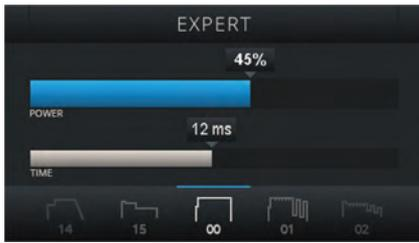
Nach dessen Aktivierung erscheint der Experten-Modus als eigene Bedienelemente, die durch Drücken des Drehreglers für eine Sekunde erreichbar ist. Im Expertenmodus sind die verschiedenen Schweißkurven zu
