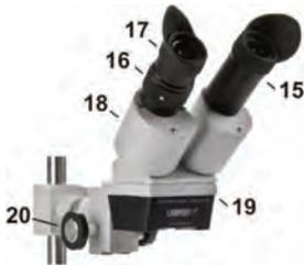
Mikroskop-Kopf (19) mit einer Hand, ohne dabei eine Linse zu berühren, und lösen mit der anderen Hand die
