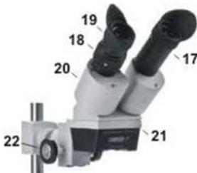
Montieren Sie ein Schweißhandstück mit eingespannter Elektrode im Haltearm. Drehen Sie den Fokussierknopf (22) auf einen mittleren Fokusbereich. Justieren der Montagehöhe des Mikroskopkopfes:
