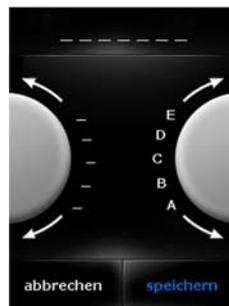
Mit dem Schweißzeitregler (25) wählen Sie die aktive Cursor-Position und mit dem Leistungsregler (26) das gewünschte Zeichen aus. Haben Sie den Namen eingegeben, bestätigen Sie die Eingabe durch Betätigen der Schaltfläche „speichern“.
