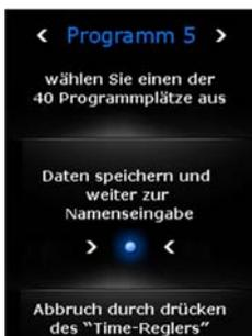
Durch Drücken des Schweißzeitreglers (25) wird das Programmiermenü aufgerufen. Im ersten Schritt wählen Sie durch Betätigen der Pfeile den Programmplatz aus, in dem Sie Ihre eigenen Einstellungen abspeichern möchten. Danach speichern Sie Ihre Daten, indem Sie die Schaltfläche mit dem
